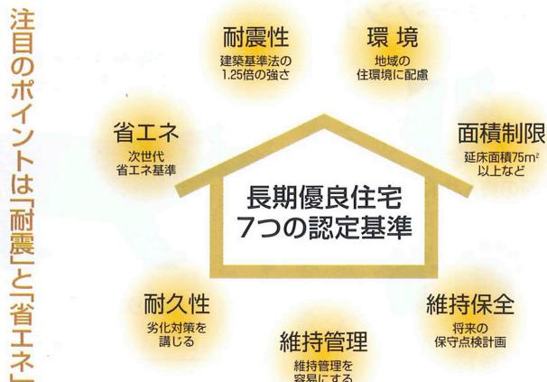
\*耐震等級1=建築基準法と同等の耐震性、耐震等級2=建築基準法×1.25倍の耐震性、耐震等級3=建築基準法×1.5倍の耐震性
